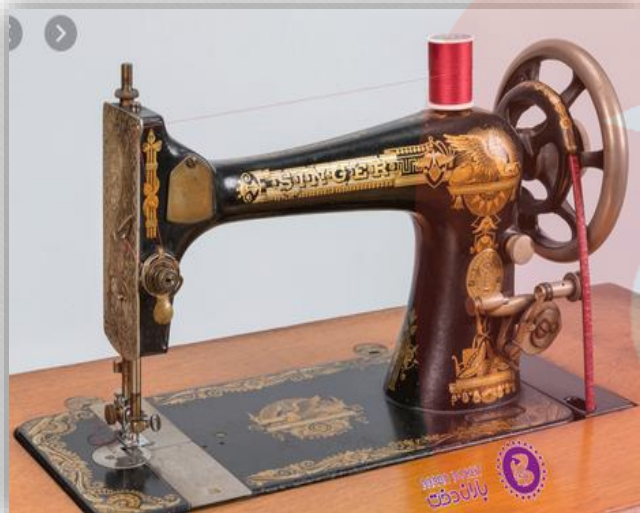
ساز و کار حرکتی چرخ تسمه در چرخ خیاطی
